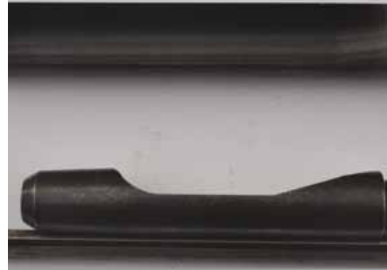
Holle pennen of tot midden afgeslepen met uitgeslepen wangen lossen beter.
