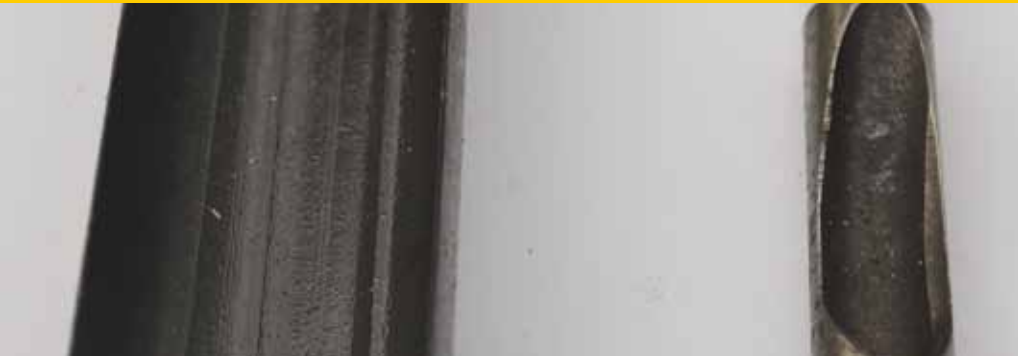
Hoogte en vorm van wangen beïnvloeden het lossen van de core.
